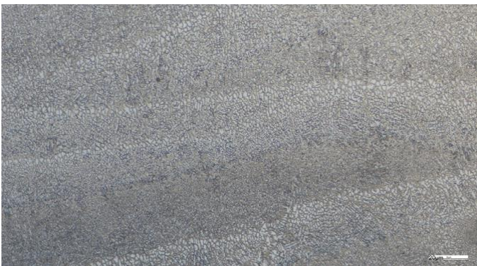
极细微组织由铁素体、马氏体和共晶混合而成
